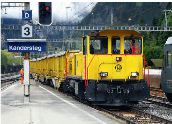
12 Schotterzug mit Diesellok Em 831 Gravel train with Em 831 diesel locomotive
