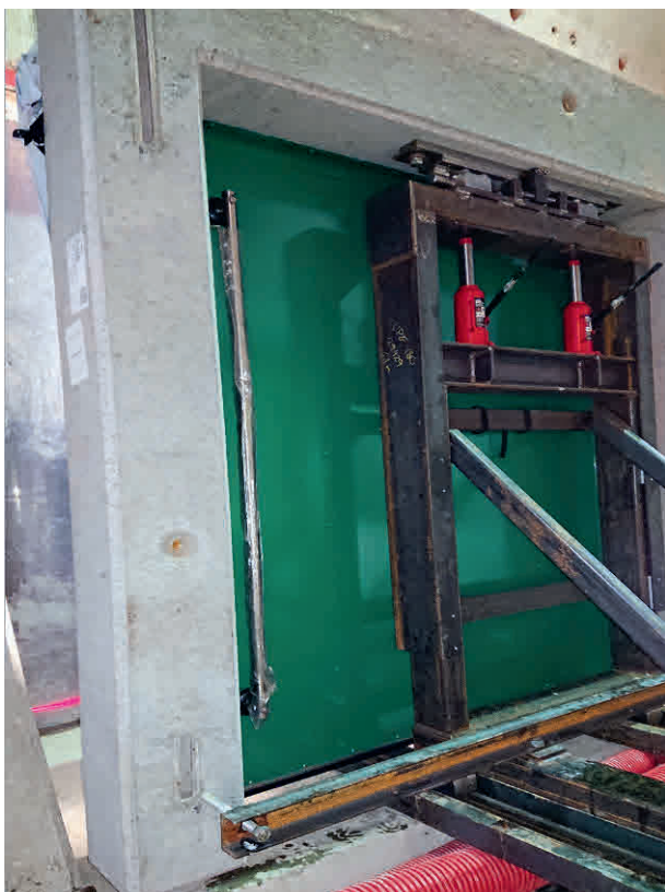
3 Installation eines kleineren Wandmoduls Installation of a smaller wall module
