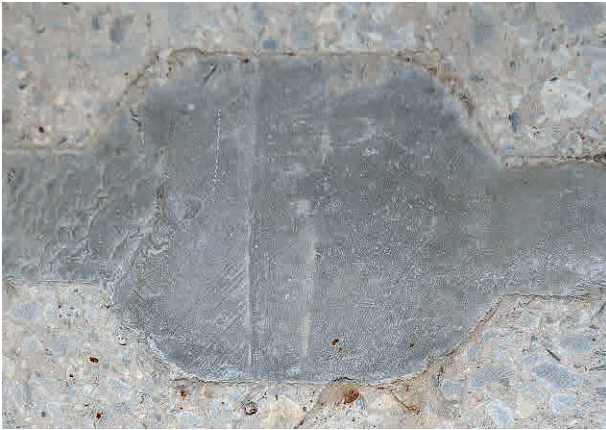
4 Schnitt durch eine Fuge mit Schlauch-Verpresssystem Sectional view through a joint with hose injection sealing system
