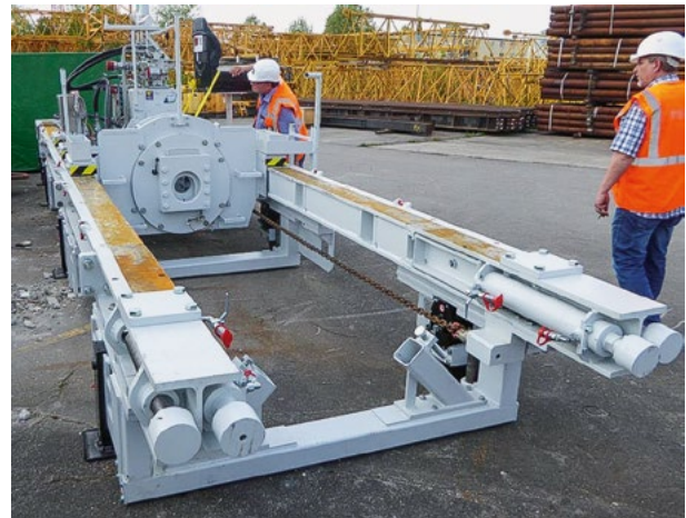
10 Pressbohrgerät als Basis des steuerbaren Bohrsystems Thrust boring unit as basis for controllable drill system
