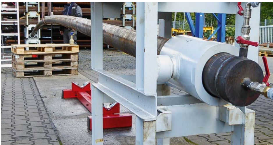
11 Rohrbiege- und Dichtigkeitsprüfung Tunnel bend and leak test
