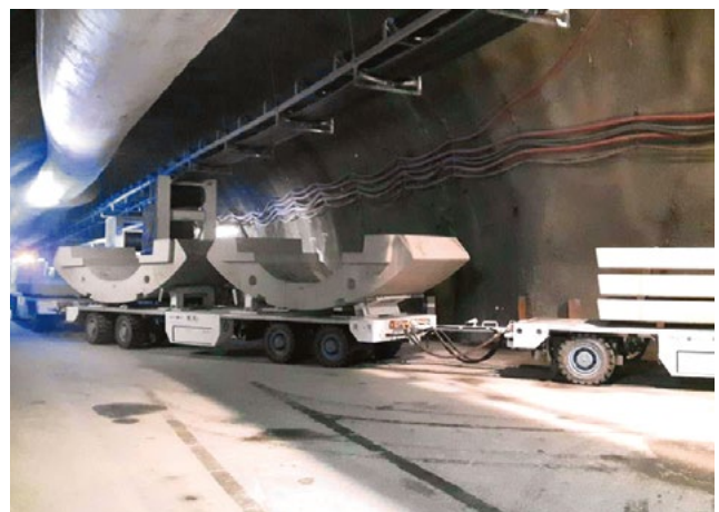
1 RowaTrain zur gleislosen Versorgung des Erkundungsstollens am BBT, Baulos Ahrental (links); Durchfahrt am Fuss des Zufahrtstollens mit R = 30 m (rechts)
