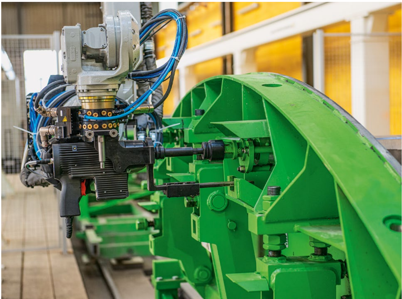
6 Der Drehmomentschrauber im Einsatz an der Schalung The torque screwdriver in use on the formwork
