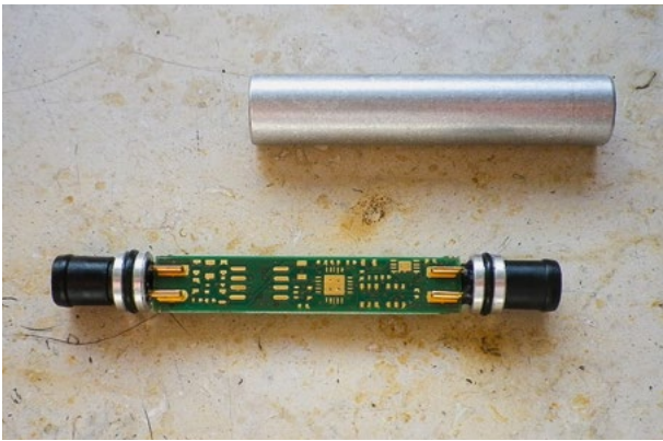
21 Digitaler Temperatursensor mit Steckverbinder Digital temperature sensor with connector
