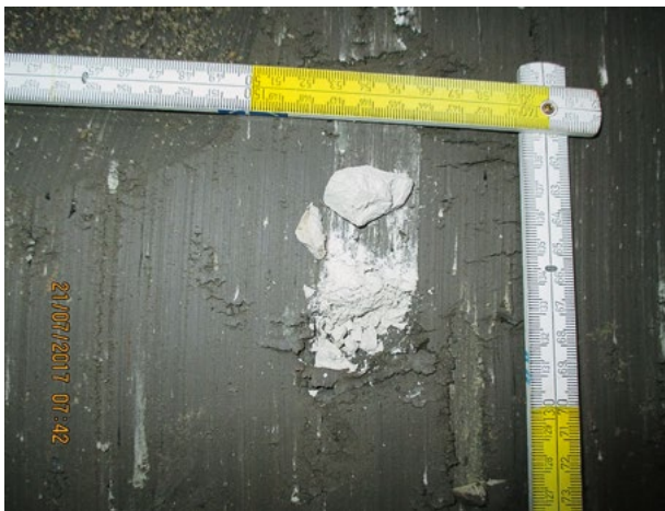
7 Saalekaltzeitlicher Geschiebemergel mit Kalkkonkretionen Saale Ice Age till with limestone concretions
