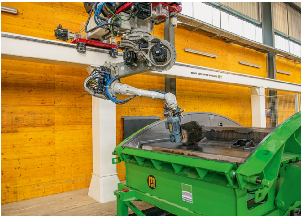
1 Der Roboter im Einsatz mit der Reinigungsbürste The robot in use with the cleaning brush
