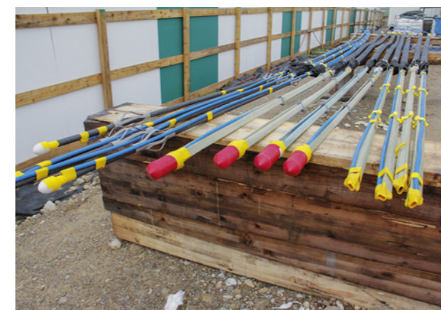
5 Verschiedene als Versuchsanker vorbereitete GFK-Ankersysteme Various GRP bolt systems prepared as test bolts
