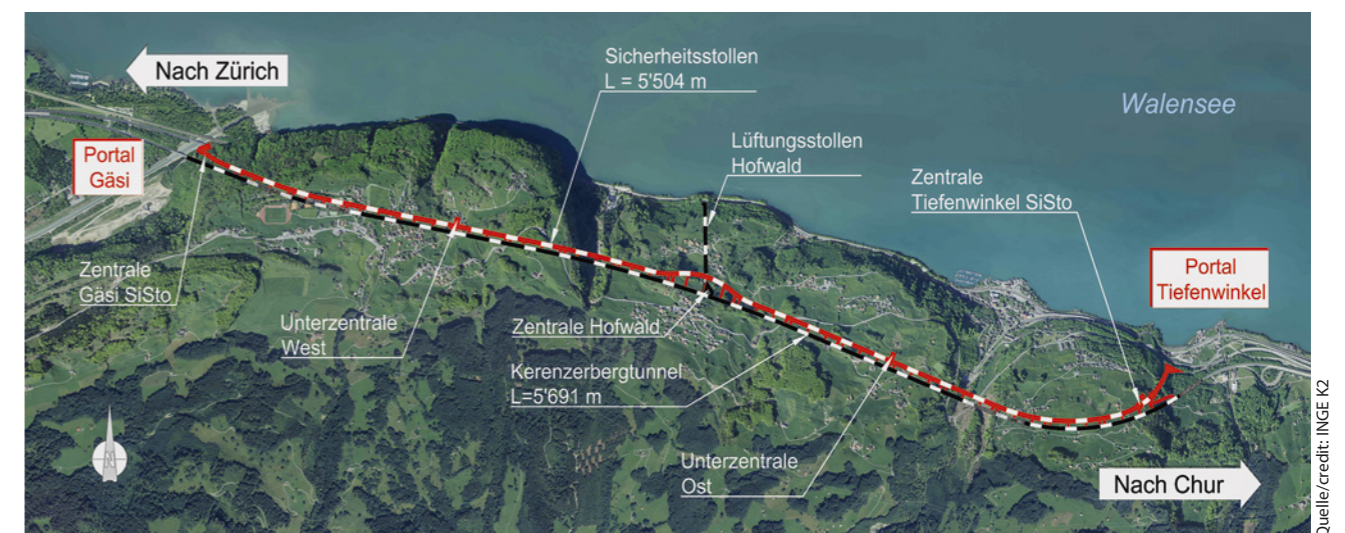
1 Situation Kerenzerbergtunnel mit Sicherheitsstollen Kerenzerberg Tunnel situation with safety gallery
