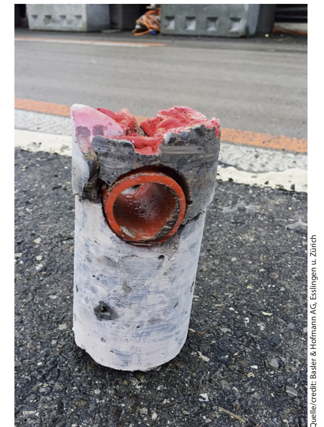
8a/b Riss im First (blau hervorgehoben)/Kernbohrung (Firstbereich, mit Hüllrohr) Crack in the roof (emphasised in blue)/drilling core (roof area, showing electrical conduit)
