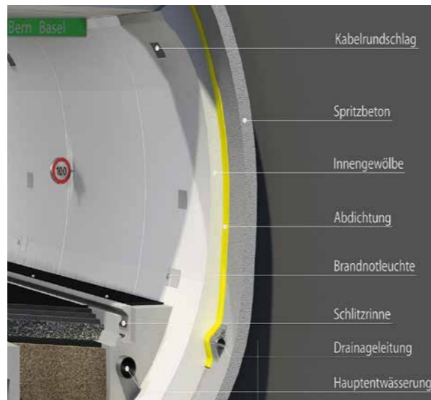
3 Ausschnitt Tunnelentwässerung Section of tunnel draining system
