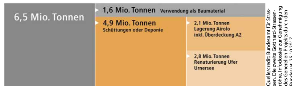
9 Wiederverwendung des Ausbruchmaterials Reuse of excavated material
