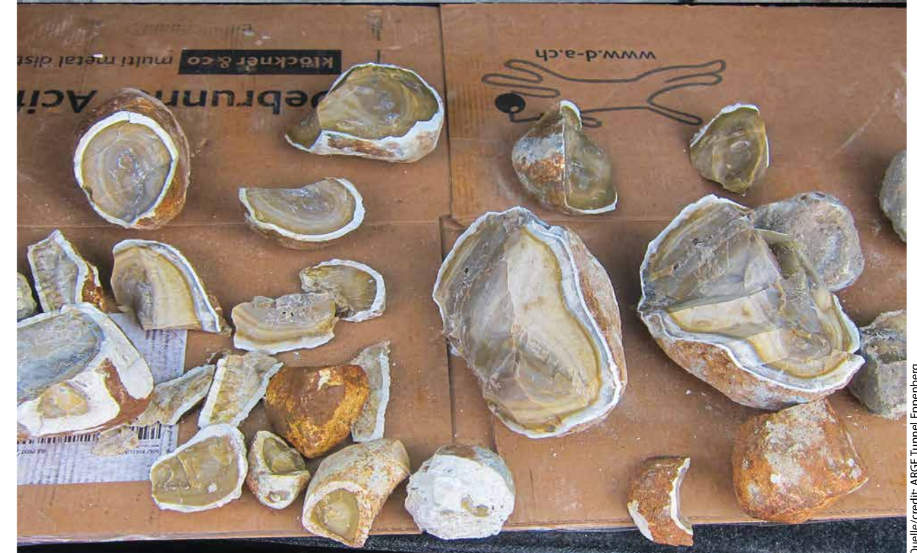
7 Oben: Silexknollen in der Ortsbrust. Unten: Silexknollen, entnommen vom Förderband Top: siliceous nodules in the work face. Bottom: siliceous nodules taken from the conveyor belt
