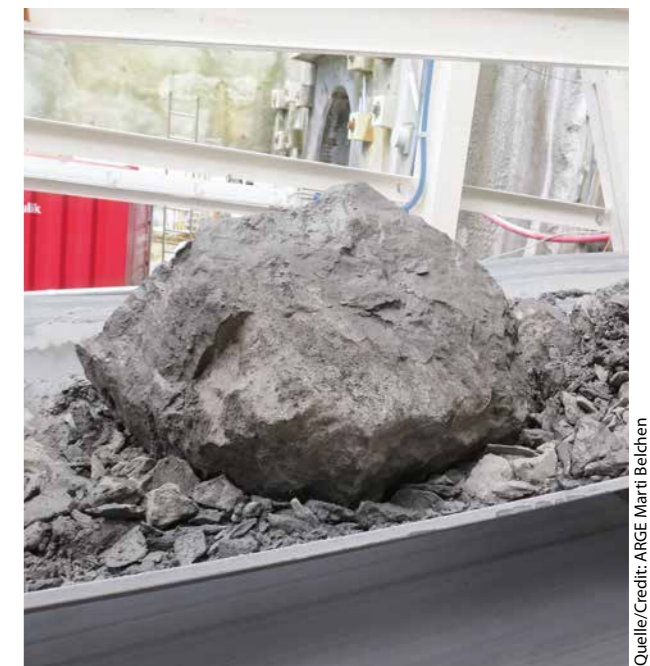
7 Typische Opalinustonblöcke auf dem Förderband Typical Opalinus clay blocks on the conveyor belt
