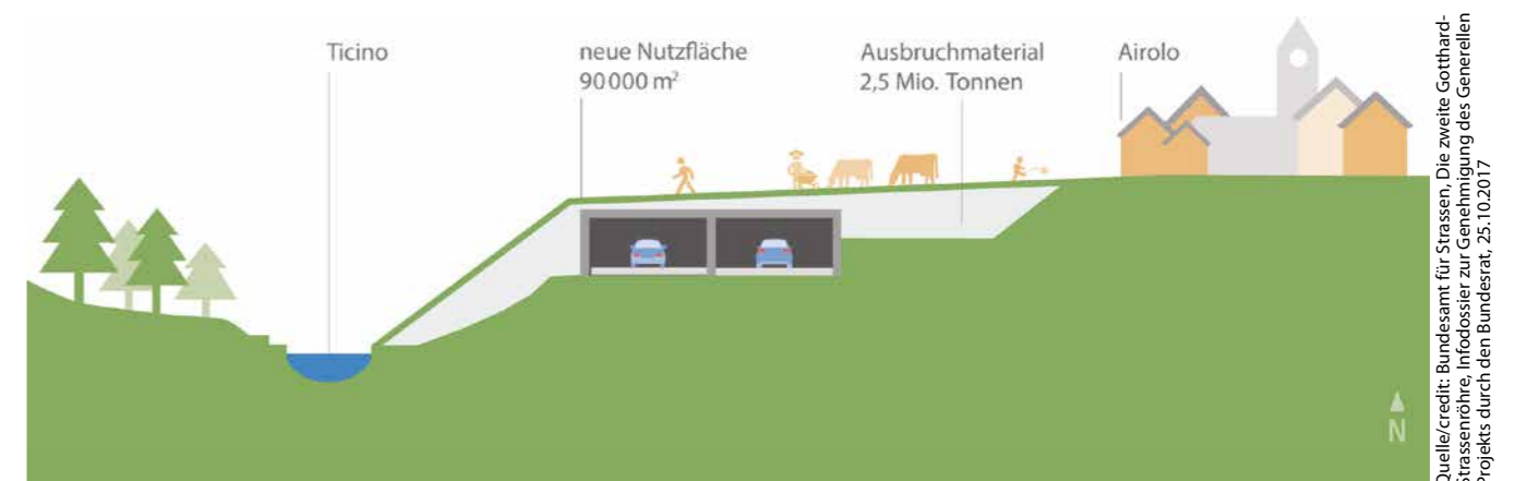
10 Visualisierung Überdeckung Galleria di Airolo Visualisation of covering of Galleria di Airolo
