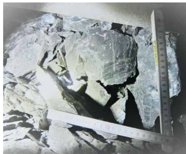
6 Backsteinartige Blöcke des Gansinger Dolomits im Schneidrad bei Tunnelmeter 937 Brick-like blocks of Gansinger dolomite in the cutting wheel at tunnel metre 937
