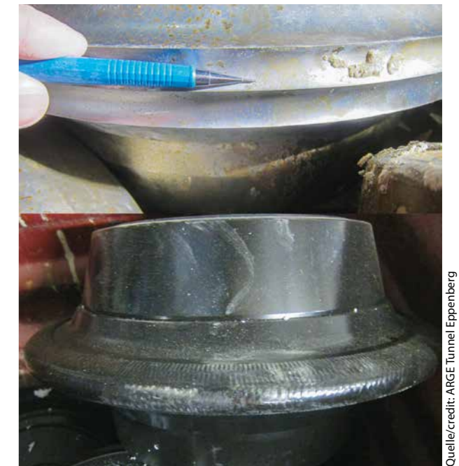
9 Oben: Verschleiss an Schneidrollen. Unten: verstärkte Schneidrollen
