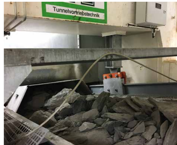
11 Überfülltes Maschinenband Overloaded machine belt
