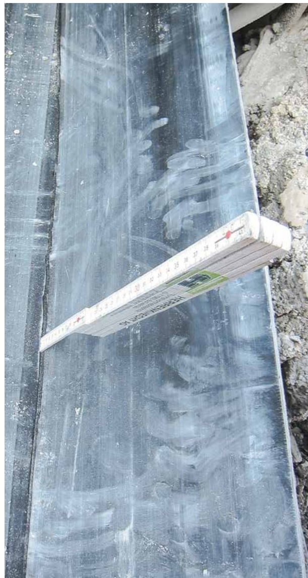
5 Defekt an Förderbandgurte während der Durchörterung der Flexurzone Fault on the conveyor belt while cutting through the flexure zone
