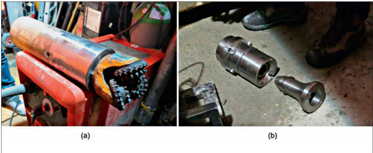
10 Verlorene Bohrkronen (a) und Teile des Ausklinkmechanismus (b) Lost drill bit (a) and parts of the release mechanism (b)
