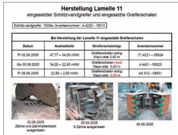
10 Eingesetzte Greifer und Schäden Grabs used and damage caused
