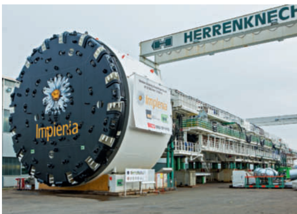
12 Montierte Tunnelbohrmaschine beim Hersteller Herrenknecht (Werksabnahme) Assembled tunnel boring machine at manufacturer Herrenknecht (factory acceptance)
