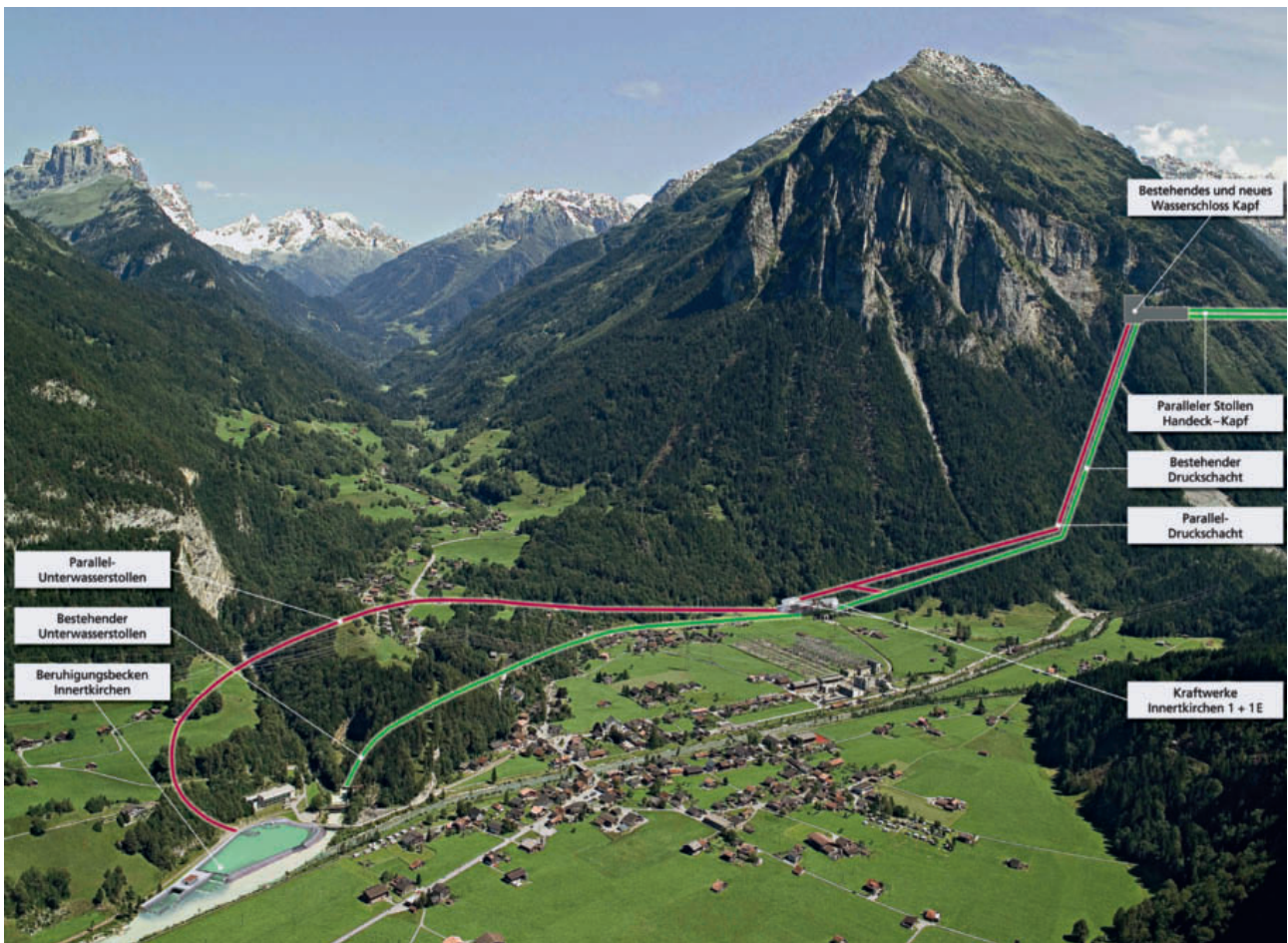
2 Projektübersicht Aufwertung Kraftwerk Innertkirchen 1
