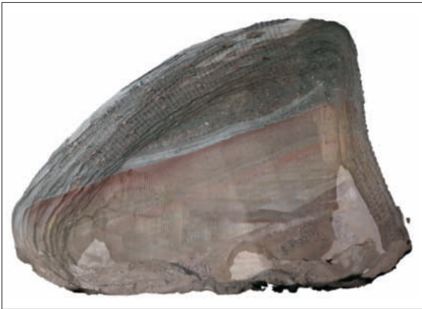
10 3D-Fotomodell der Ortsbrust (mit rötlichem Mergelband) der geologischen Aufnahmen TU 3D photographic model of the face (with reddish marl band) from the DBC's geological surveys
