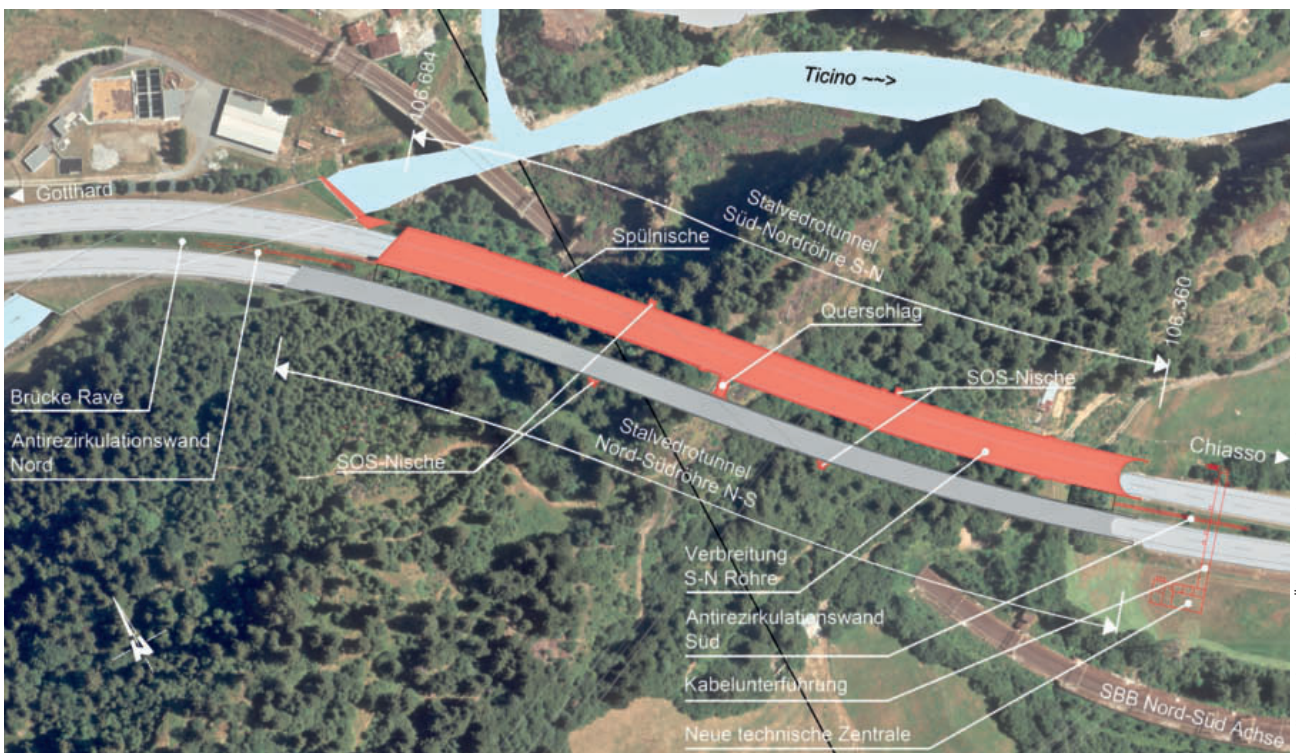
1 Übersicht Projekt Stalvedrotunnel mit den geplanten Massnahmen Overview of the Stalvedro tunnel project with the planned measures
