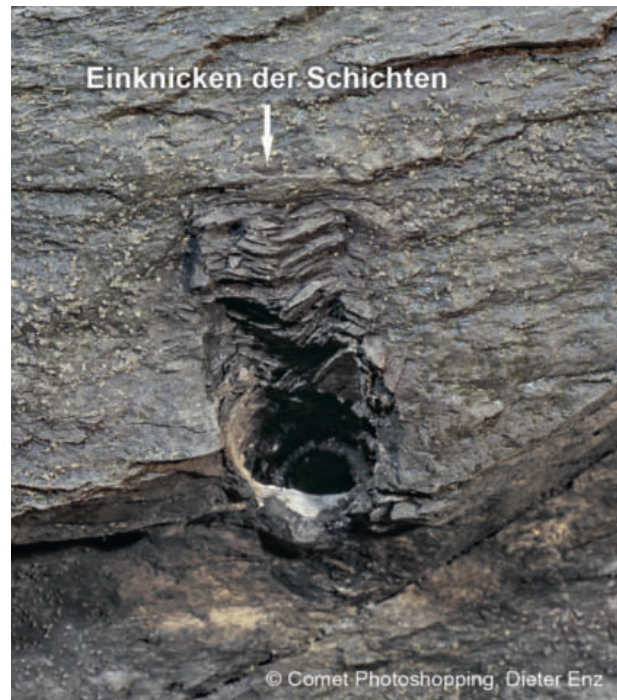
5 Foto der Auflockerungszone um ein Bohrloch im Opalinuston (Felslabor Mont Terri) Photo of the loosened zone around a borehole in the Opalinus clay (Mont Terri rock laboratory)
