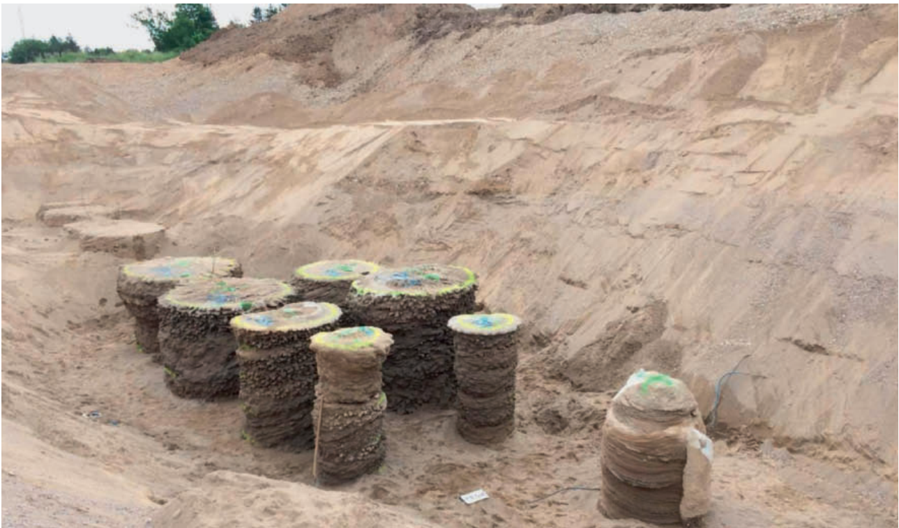
10 Freigelegte Probesäulen Tunnel Srejach Exposed test columns, Srejach Tunnel
