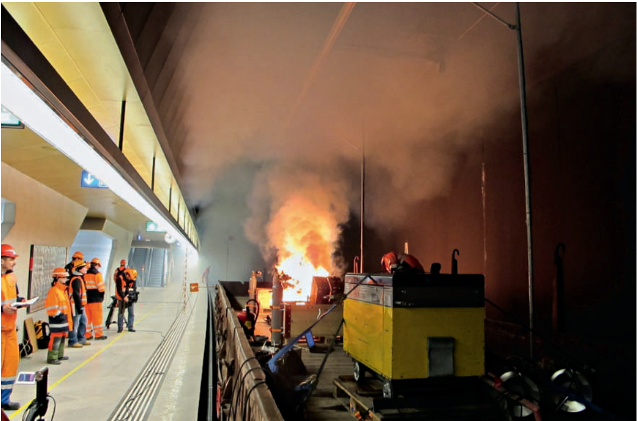
4 Rauchversuchsanlage auf Flachwagen Smoke test apparatus on a railway flat car
