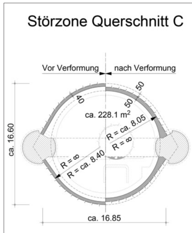
4 Ausbruchgeometrie Störzone Querschnitt C: Kalotten-/Strossen- und Sohlenvortrieb mit vorgängig erstellten und mit Beton verfüllten Widerlagerstollen
