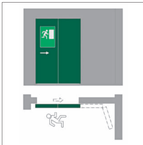
5 Gliederschiebetür Segmental sliding door
