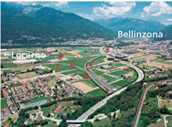
3 Knoten Camorino, offene Strecken am Nordportal des Ceneri-Basistunnels: 1) Nordportal Ceneri-Basistunnel; 2) Bahnlinie Bellinzona–Locarno/Luino; 3) vierspurige Brücke über die Autobahn A2; 4 + 5) eingleisige Bahnviadukte; 6) vierspurige Kantonsstrassenunterführung; 7) Bahnlinie in Richtung Locarno The Camorino Node, surface lines at the north portal of the Ceneri Base Tunnel: 1) Ceneri Base Tunnel, north portal; 2) Bellinzona to Locarno/Luino rail line; 3) four-track bridge over the A2 autobahn; 4 + 5) single-track rail viaducts; 6) four-lane regional-road underpass; 7) rail line to Locarno
