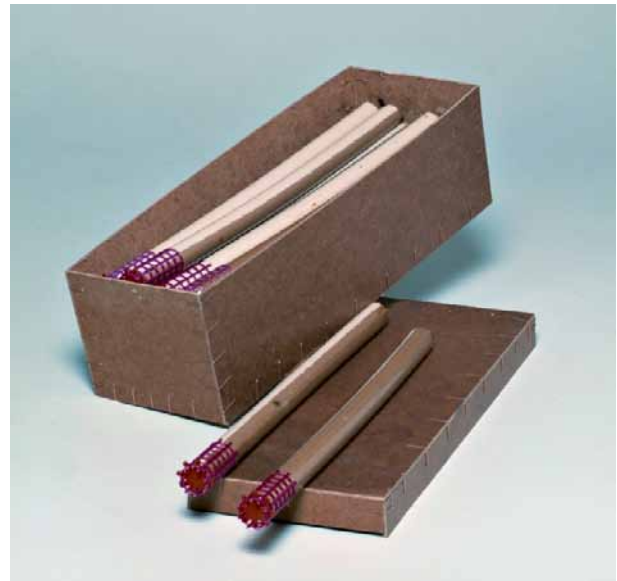
7 Klebepatronen: Das Harz-Quarzgemisch und der Härter sind in getrennten Kammern eingepackt Resin cartridges: The resin/silica sand mixture and the hardener are prevented from reacting by a film barrier inside the polyester film cartridge
