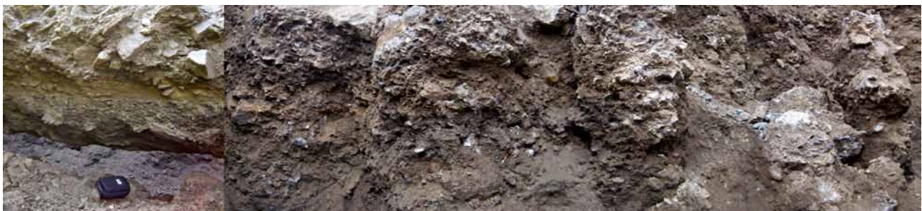
8 Jetting-Versuche a) vor Ausschreibung, b) mit Unternehmung Jetting tests a) prior to tender, b) with contractor
