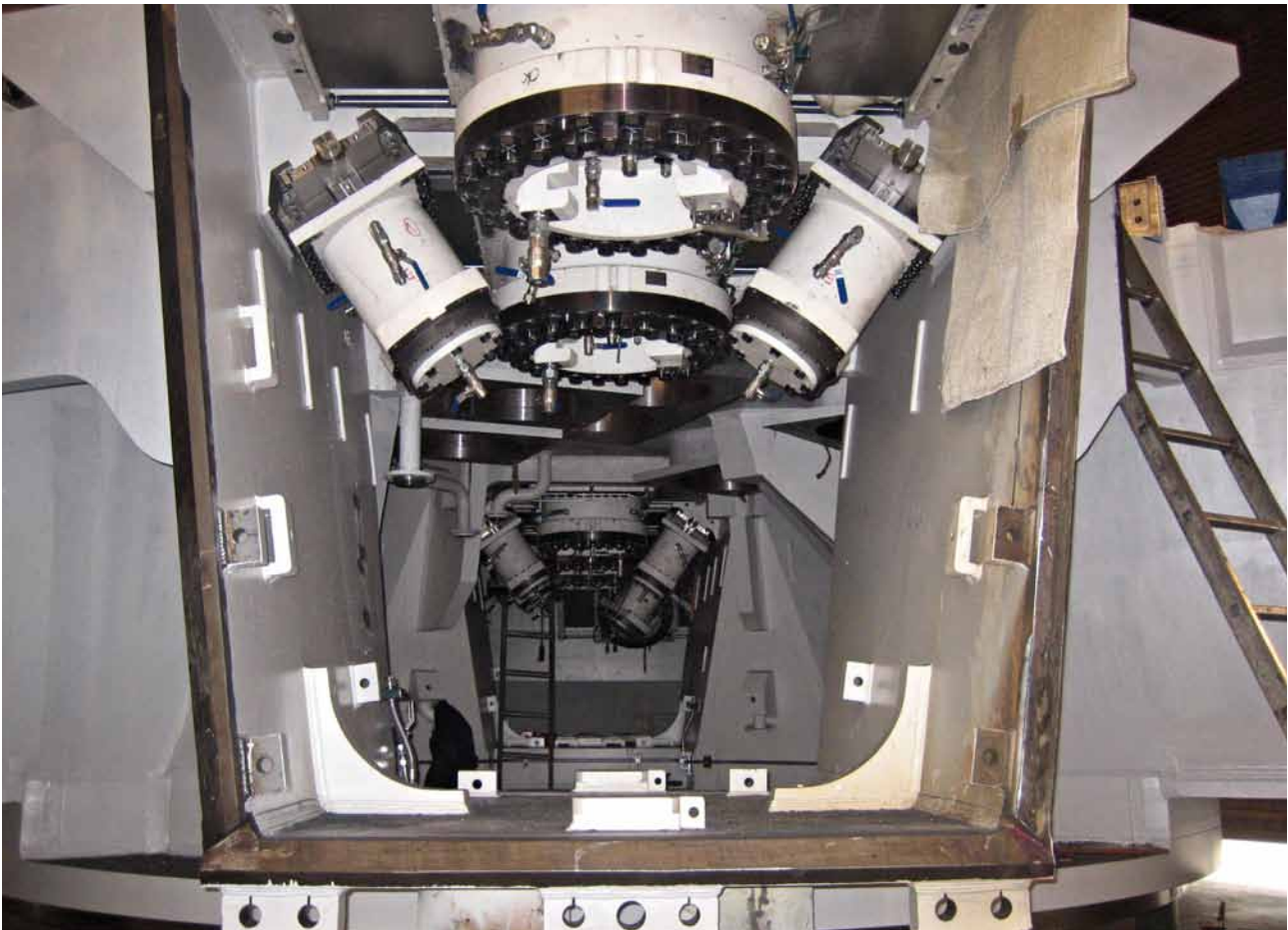
7 Inneres des Schneidrads mit Rückansicht der Ausrüstung für unter atmosphärischen Bedingungen im Zentrum wechselbare Schneidrollen während der Vormontage der Schneidradarme Cutterhead interior with rear view of the fixtures for atmospheric exchangeable disc cutters in the center during preassembly of the cutterhead arms
