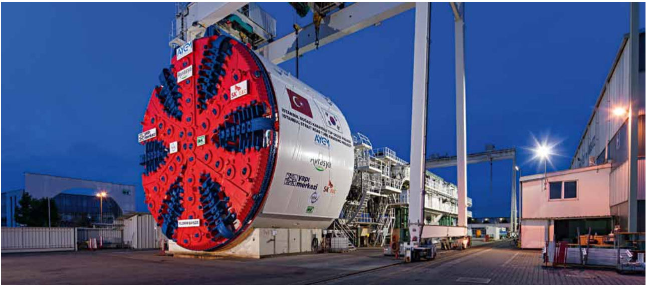
4 Vormontiertes Mixschild im Herrenknecht-Werk in Schwanau/D Pre-assembled Mixshield at the Herrenknecht factory in Schwanau/D
