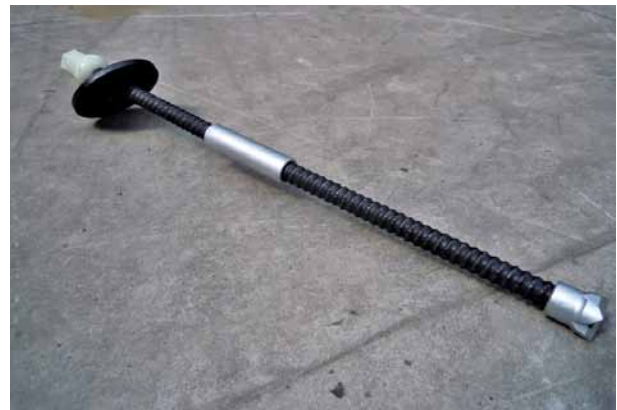
9 Selbstbohranker aus einem pultrudierten GFK-Hohlstab mit durchgehendem Gewinde, glasfaserverstärkter Ankerplatte und Mutter, Verbindungsmuffe und Bohrkronen aus Stahl Self-drilling rockbolt from pultruded GFRP hollow bars with continuous thread, fiberglass reinforced face plate and nut, steel coupler connection and steel drill bit
