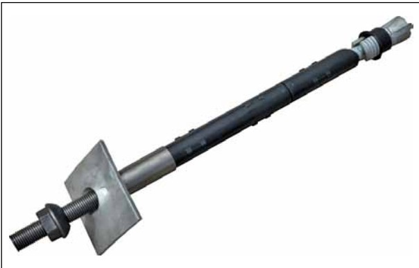
5 Kombi-Spreizanker: als temporäre Sicherung installiert und später als Teil einer permanenten Sicherung nachinjiziert Combi-rockbolt: installed as temporary support, later post-grouted as part of a permanent solution
