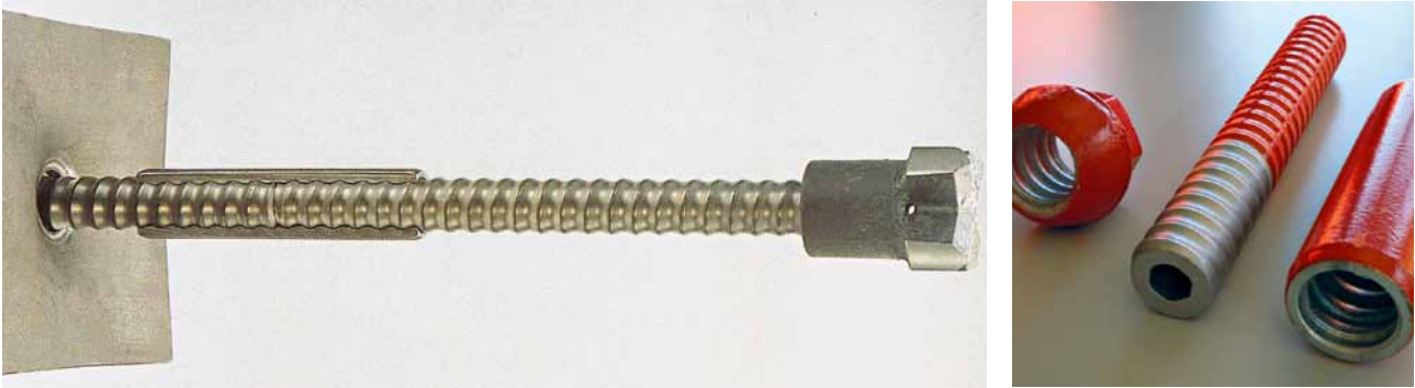
8 Selbstbohranker, bestehend aus dickwandigem Stahlrohr mit geroltem Grobgewinde, verlorener Bohrkronen, Verlängerungsmuffe, Ankerplatte und Mutter (li.); Doppelter Korrosionsschutz für den permanenten Einsatz (re.) Self-drilling rockbolt, composed of a thick-walled steel tube with coarse thread, one-way drill bit, coupler connection, anchor plate and nut (left); Double corrosion protection for a permanent application (right)
