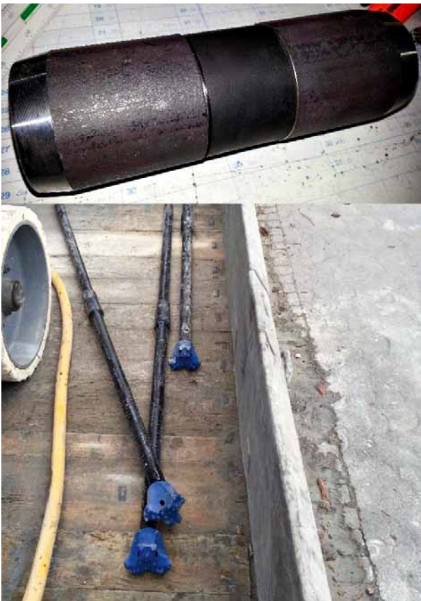
6 Autoforeur avec longueur libre et manchon ré-injectable Self-driller with free length and re-injectable sleeve
