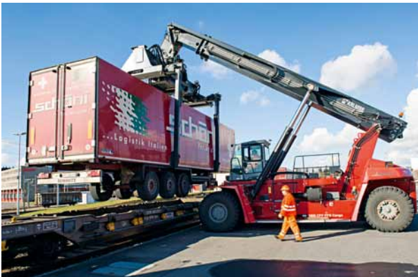
2 Die SBB wird bis 2020 die Strecke von Basel ins Tessin so ausbauen, dass auch Sattelaufleger mit 4 m Eckhöhe transportiert werden können SBB will upgrade the route from Basel to Ticino so that it is compatible for articulated trailers with a 4-metre headroom requirement
