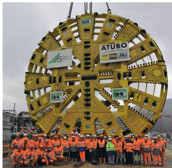
6/7 Schneidräder der Vortriebe für Fels und Lockermaterial: Hydro-Mixschild (Weinbergtunnel, Bild 6, blau) und EPB-Mixschild (Umfahrung Biel Ostast, Bild 7, gelb) Cutting wheels for the drives in rock and soft material: hydro-mix-shield (Weinberg Tunnel, Fig. 6, blue) and EPB mix-shield (Biel East Bypass, Fig. 7, yellow)
