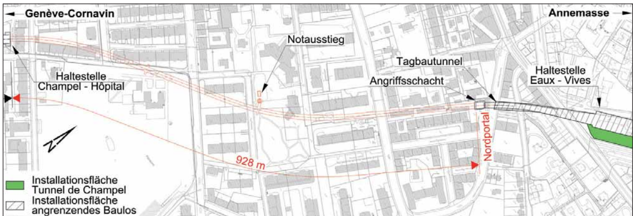
4 Übersicht über den nördlichen Abschnitt des Tunnel de Champel Plan view of the northern section of the Tunnel de Champel
