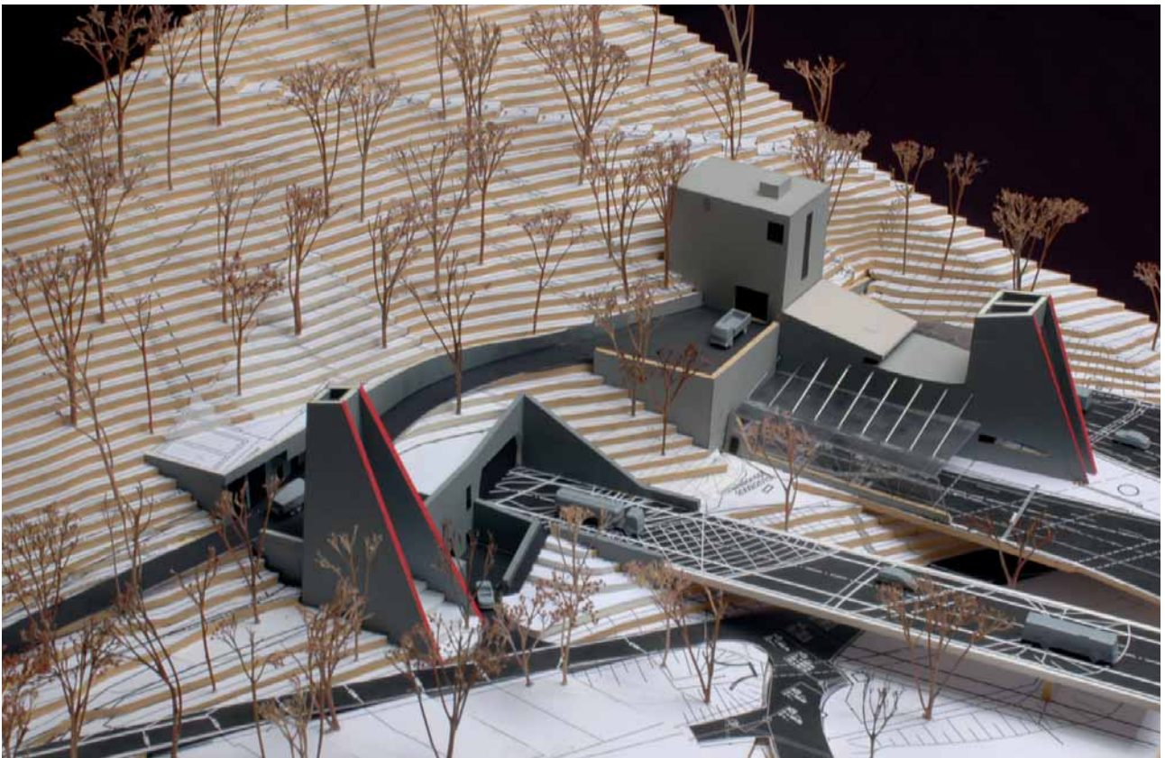
19 Modell Portal Süd: bestehendes Tunnelsystem mit STB (linke Tunnelröhre) Model of the south portal: existing tunnel system with STB (left tunnel bore)
