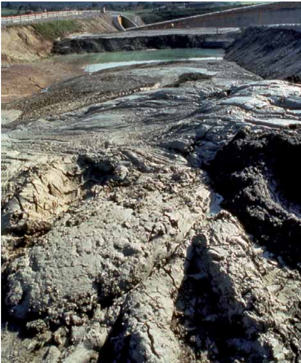
8 Beispiel Verklebung durch toniges Material Example of clogging caused by clayey material
