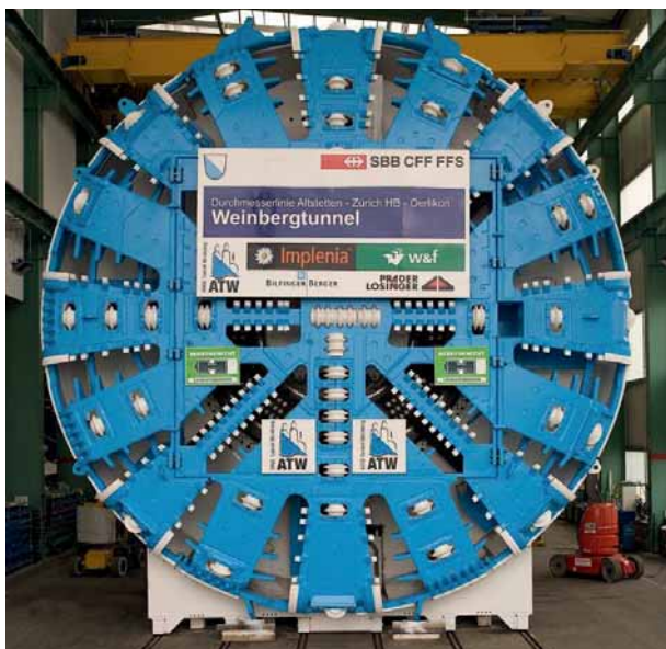
6/7 Schneidräder der Vortriebe für Fels und Lockermaterial: Hydro-Mixschild (Weinbergtunnel, Bild 6, blau) und EPB-Mixschild (Umfahrung Biel Ostast, Bild 7, gelb) Cutting wheels for the drives in rock and soft material: hydro-mix-shield (Weinberg Tunnel, Fig. 6, blue) and EPB mix-shield (Biel East Bypass, Fig. 7, yellow)
