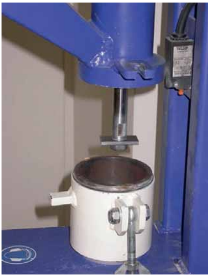
1 Versuchsanordnung modifizierter LCPC-Test (aus [10]) Test setup for Modified LCPC Test (from [10])
