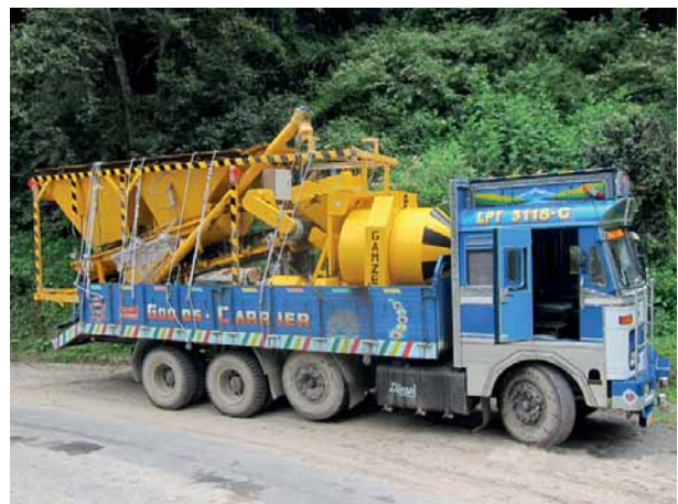
9 Bhutanischer Schwertransport: Anlieferung einer kleinen Betonanlage Bhutanese heavy transport: delivering a small concrete plant
