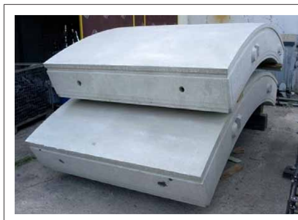
6 Voussoirs en fabrication Concrete segments under construction
