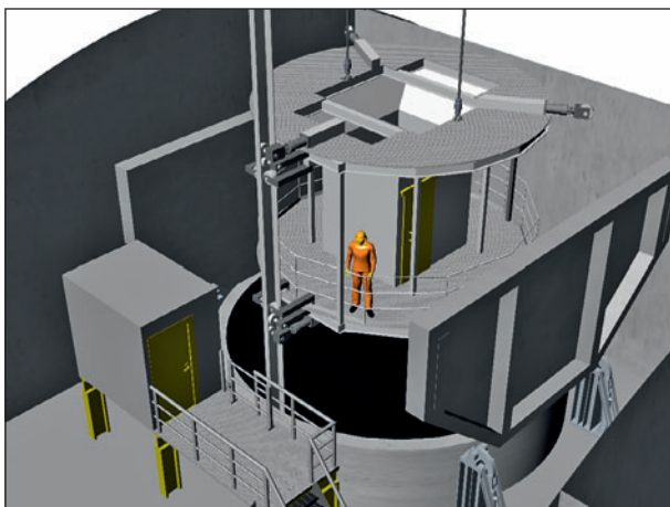
6 Hebeeinrichtung bei Einfahrt in Schacht I, 3D-Darstellung Hoisting installation when entering shaft I, 3D presentation
