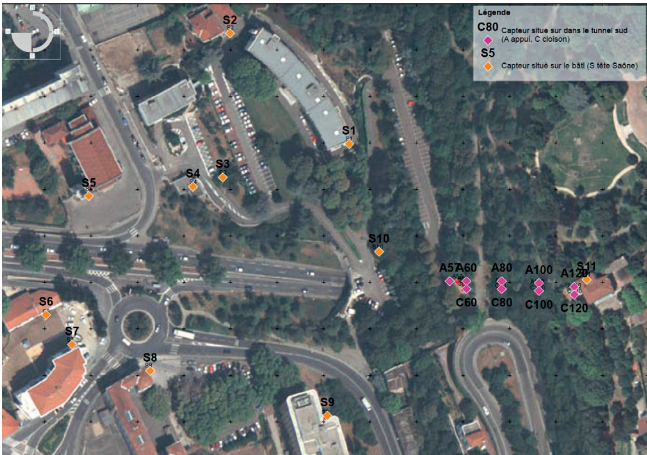
7 Dispositif d'enregistrement pour les tirs d'essais – côté Saône Recording device for test blasts – Saône side
