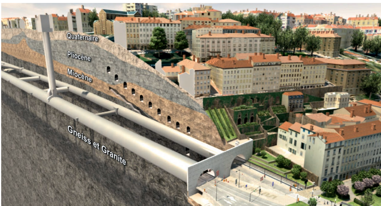
5 Profil en long géologique Geological longitudinal section
