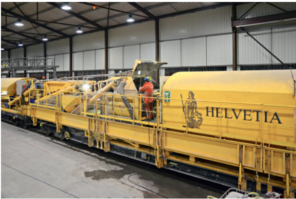
10 Das Herz des Betonzuges – Betonmischer mit Mischzentrale The heart of the concrete train – concrete mixer with central mixing unit (Foto/Photo: TTG)
