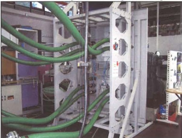
Bild 9: Dauerbelastung Druck und Sog Querschlagstüre
