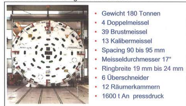
Bild 7: Die offene Gripper – TBM der Firma Herrenknecht mit den wichtigsten Kenndaten.
