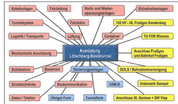
Bild 7: Die primären Leistungsmodulare der bahntechnischen Ausrüstung
