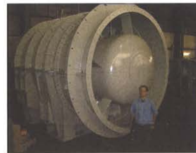
Bild 16: Abluftventilator Fystertellä der Betriebslüftung
