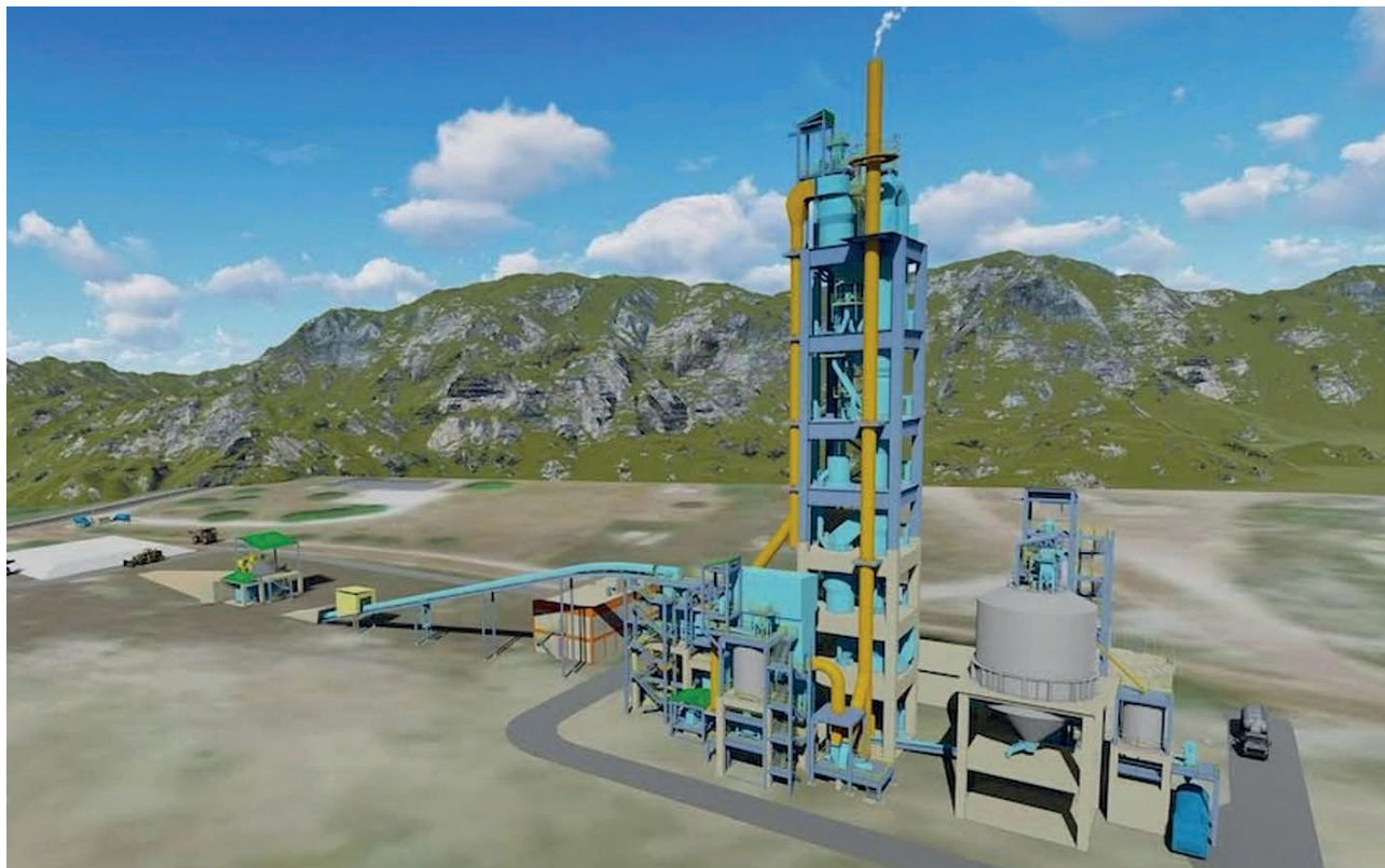
6 Vue isométrique 3D d'une usine de calcination flash dédiée aux argiles
