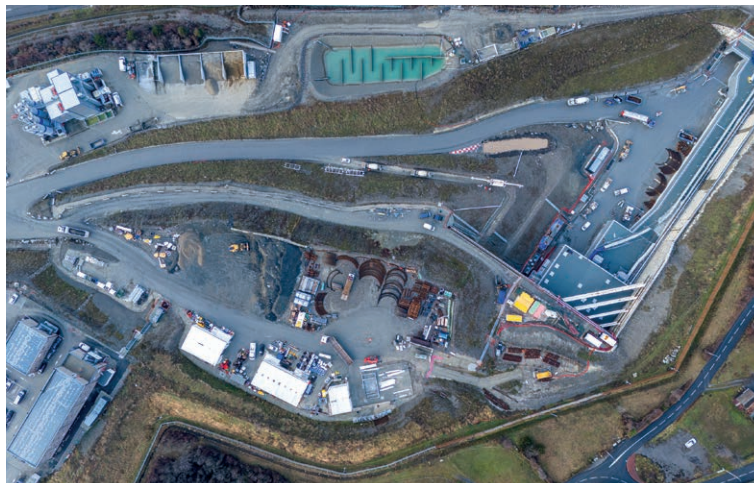
6 Luftbild Installationsplatz mit Betonanlage, Lagerflächen und Voreinschnitt
