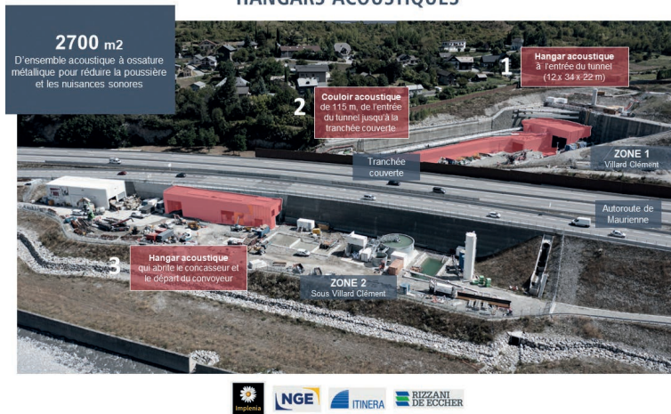
4 Luftbild Installationsplatz mit Brecherhalle und Förderbandbrücke über den Fluss Arc
