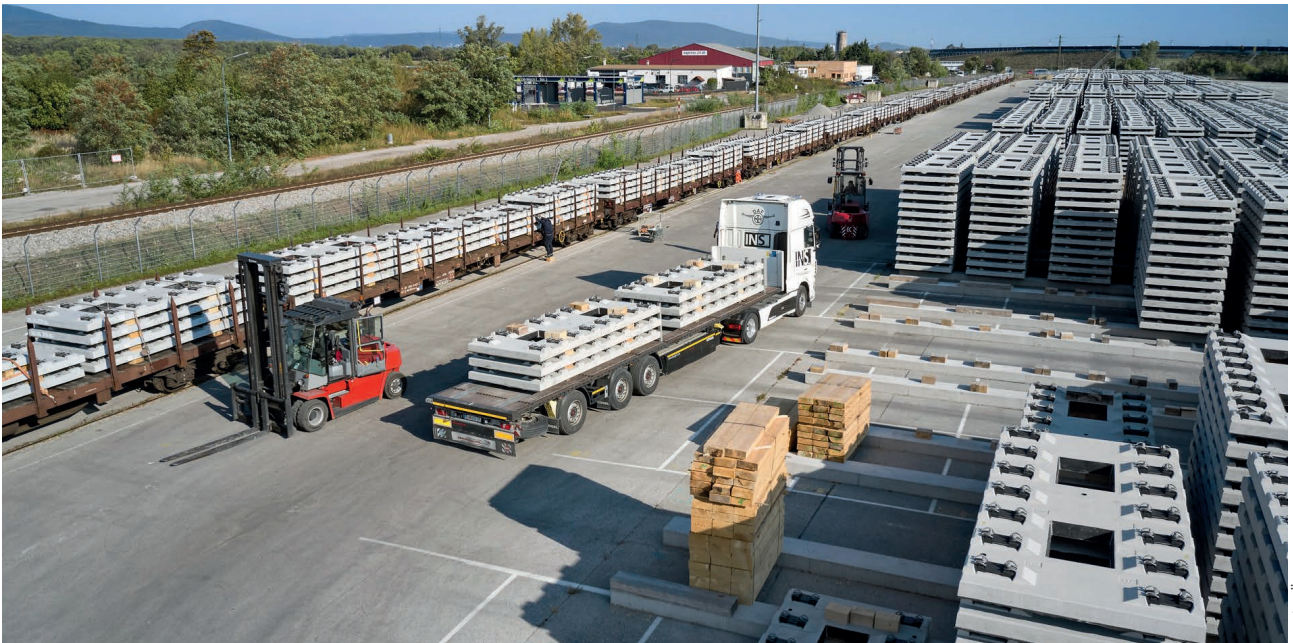
6 Elastisch gelagerte Gleistragplatten/Umschlag Strasse auf Schiene
