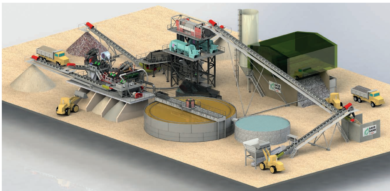
2 Vue isométrique 3D de l'usine de séparation des matériaux envisagée
