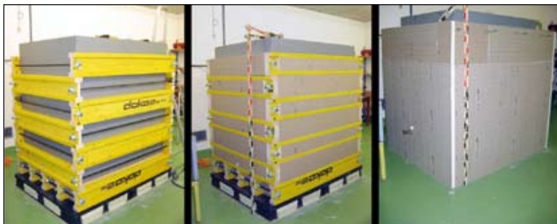
Ansichten des Gefrierkastens (die Photos entsprechen verschiedenen Bauphasen und zeigen den Aufbau der Wände inkl. Isolation).
