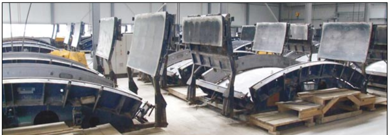
Tübbingfabrik, Schalungen der Tübbinge
